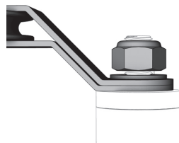
Fachgerechte Installation von PATROLANG auf TOWER - TOWER22 - TOWERA2 Stütze
